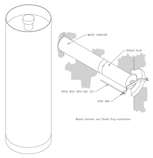
Figure DATA-B-7. RH-TRU Waste Canister Components
