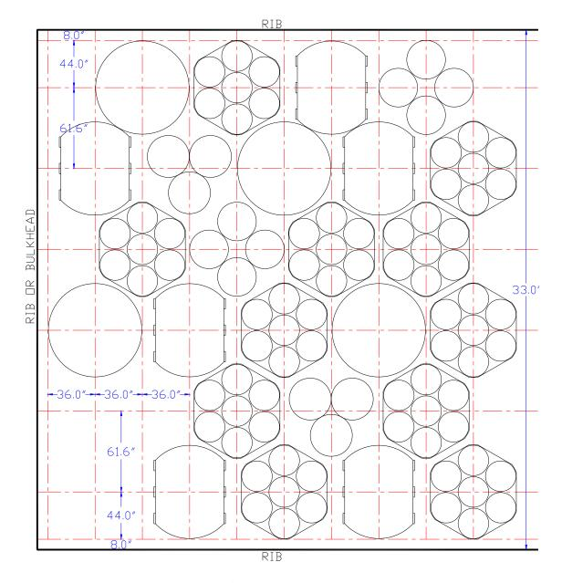
Figure DATA-B-8. CH-TRU Waste Emplacement Layout
